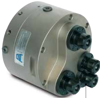
TC 40604 Testa di foratura su alluminio, punte in metallo duro, passaggio refrigerante centro utensile a 50 Bar, 9500 giri/min. Peso Kg 26. Drilling multispindle head on aluminium, hard metal tools, coolant through the centre tool at 50 Bar, 9500 Rpm. Weight Kg 26.
